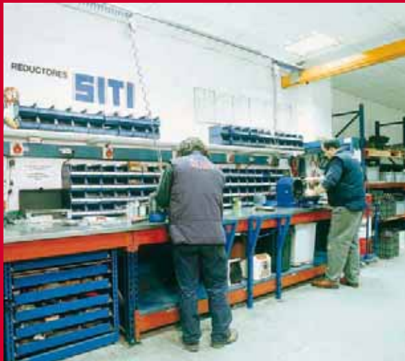
Montaje de motorreductores a partir de componentes despiezados, engranajes, bridas y Motores Eléctricos.
